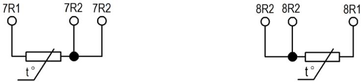
Рисунок А.5.1 - Схема подключения термопреобразователей сопротивления Pt100 или 50М
